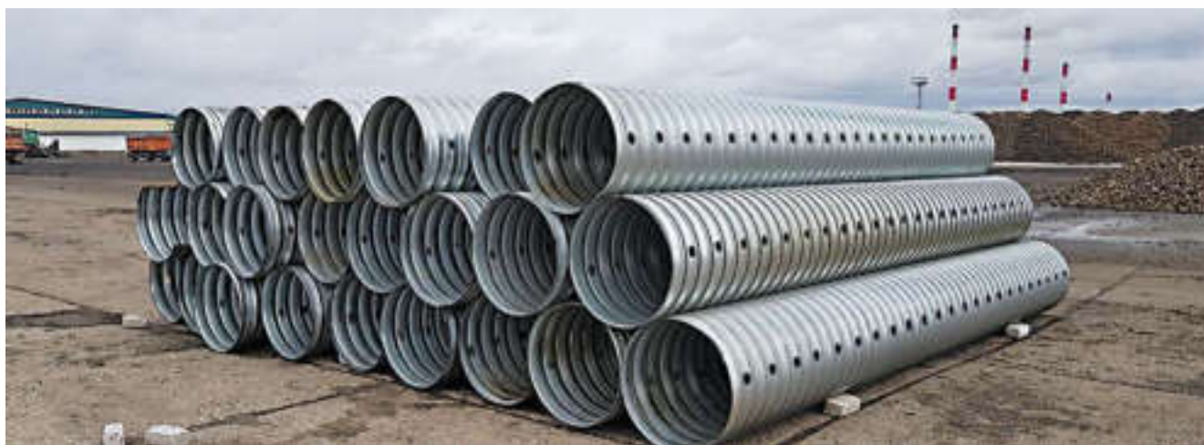
Сложенные изготовленные трубы ожидают приваривания упоров и выреза S-замка.
