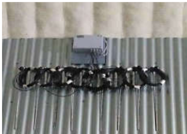
Закреплённый на стене блок датчиков продукта VENTOGLAS™. Датчики продукта соединены с блоком проводами.
