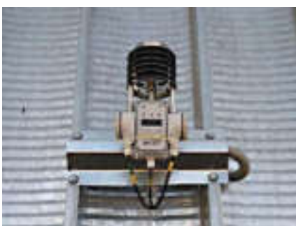
Блок уличных датчиков температуры и влажности.
