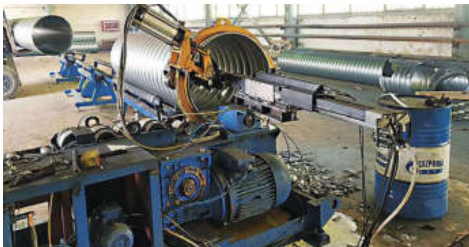
Станок для изготовления спирально навивных труб с плазменным резаком отверстий.
