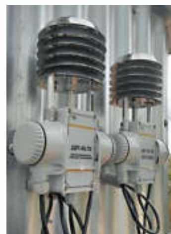
Уличные датчики от разных хранилищ установленные в одном месте.
