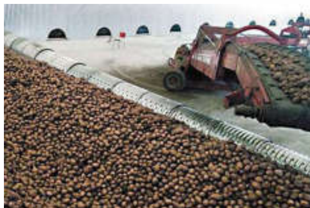
Закладка картофельного бурта с использованием напольных вентиляционных каналов Ventoglas™.
