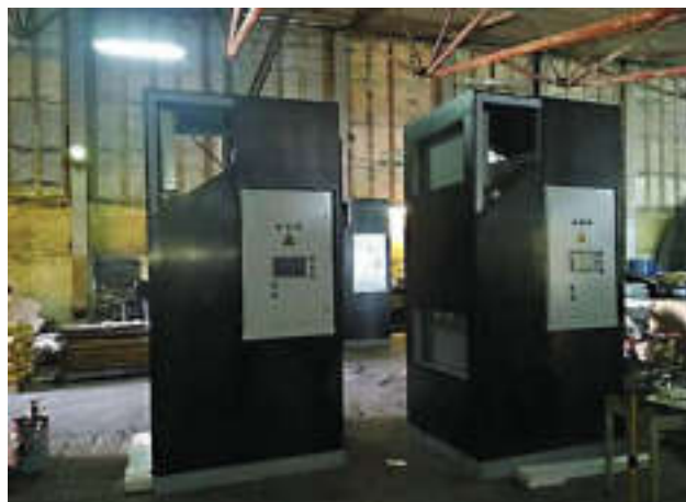
Готовые модули 01K2 со встроенными датчиками и щитом управления.
